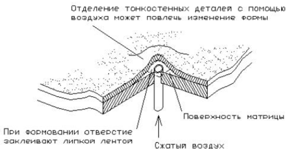
Рис. 12. Пневмосъемник.
